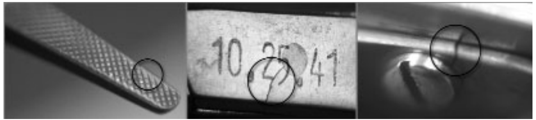
Exemples de détériorations d'instruments
