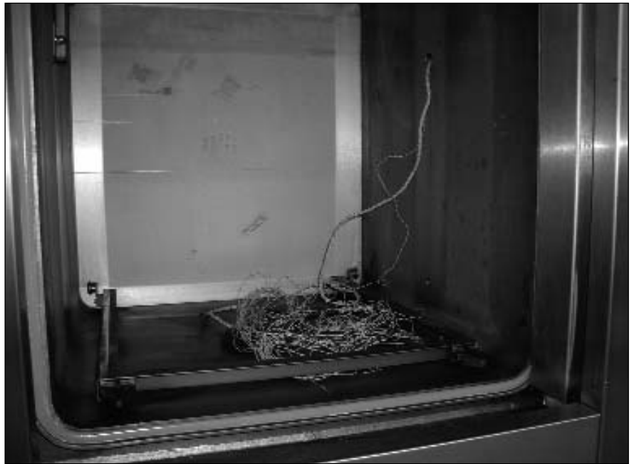
Die Fühler werden durch den Stutzen in die Kammer geführt.
